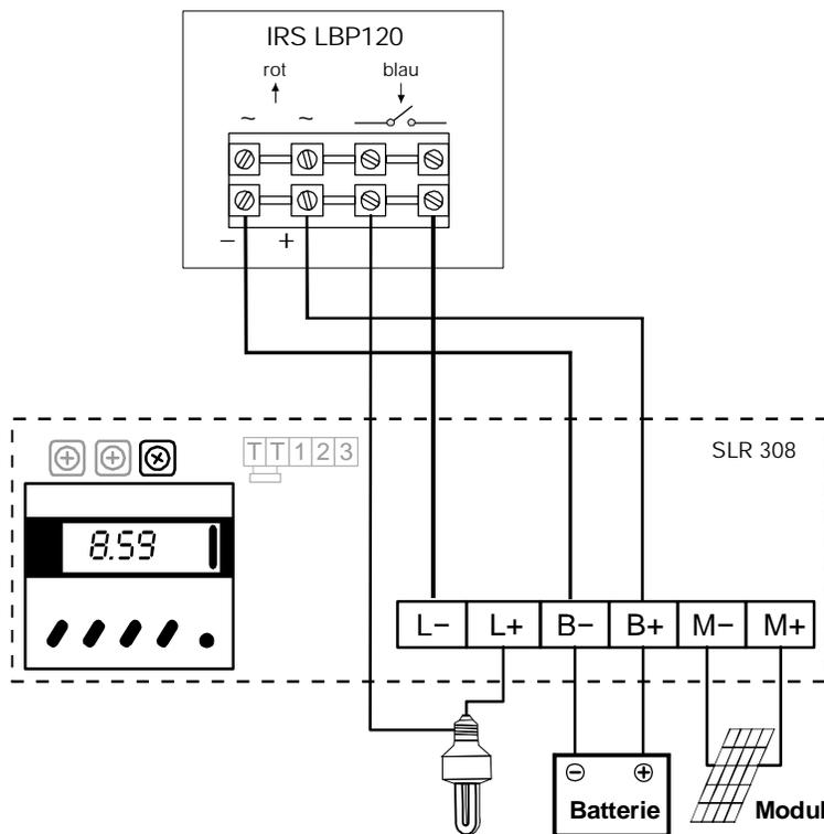
Betrieb am Laderegler SLR308/316 oder einem anderen Laderegler mit Nachtlichtfunktion. Der Tiefentladeschutz ist gewährleistet.
